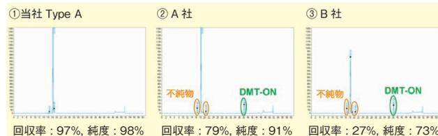
～1μmolスケールの範囲で、サンプルのロード量に関係なく同様の分離・精製挙動を示します。
