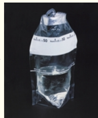
孵卵器で培養 (36 ± 1 24 時間) します。淡黄色の培地が青く変色すれば大腸菌群陽性です。紫外線 ( = 366nm ) を照射して蛍光を発すれば E.coli 陽性です。
