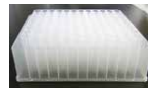
回収用ディープウェルプレート ラベル化糖鎖溶液をフィルタープレートから回収する際に使用します。
