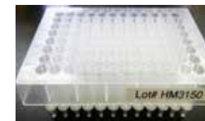
クリーンアッププレート ラベル化反応後の溶液から未反応の過剰ラベルを除去するために使用します。
