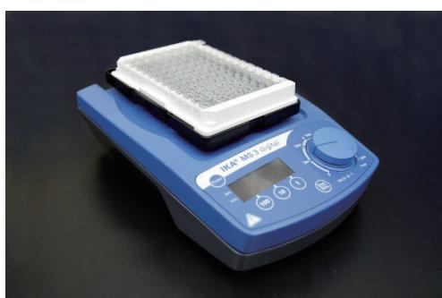
できれば、マイクロプレート・ミキサー（マイクロプレート・シェーカーとも言う）のような機器にプレートをセットし、800rpm、10秒×3回程度攪拌して下さい。
