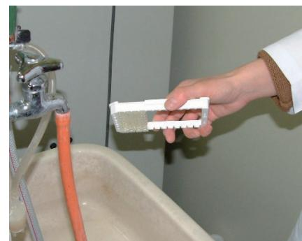
第2回目の洗浄液をウェルに加え、振盪後廃棄します。更に第3、4回目の洗浄を行います。
