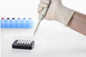
専用のMic 4連チューブには蒸散防止オイルが入っています
