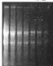
mouse spleen total RNAの2倍希釈系列を調製し、formaldehyde-1%アガロースゲルで電気泳動を行った。臭化エチジウムによる後染色は、15分間TAEバッファー中で染色した(終濃度0.5mg/ml)。前染色はRNAに1mg/mlの臭化エチジウムを0.5 µl加えて混和後、泳動し、染色なしに検出した。SYBR® Goldは40分間TAEバッファー中で染色した。302nmのUVイルミネーターで検出した。
