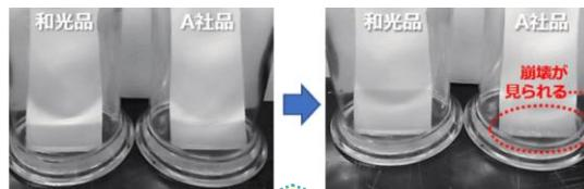
水100%でも展開可能のため、有機溶媒を使わない実験ができます。
