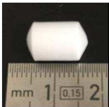
1. cellnest 水溶液の濃度・凍結条件、型によりスponジの内部構造や形状を制御できます。
